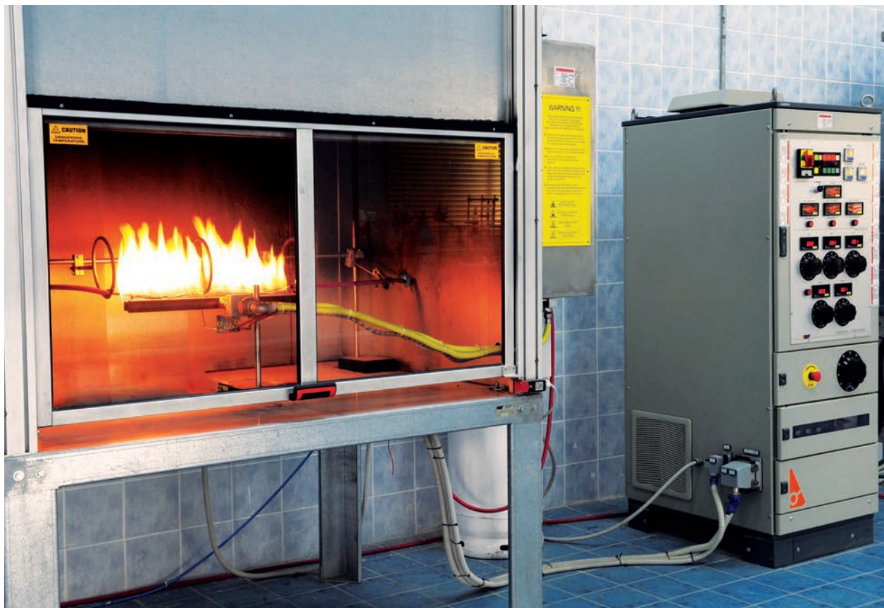
Fire resistance test (IEC 60331-21)
